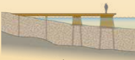
Stenkistor med pålar till berggrund.
