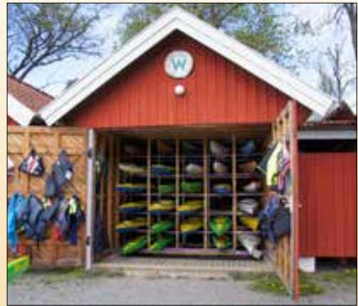
Båthuset. I detta fall med hyllor för kanoter - behöver vara nära vattnet så att lyft och transport blir kort, och med god dränering och torkmöjligheter eftersom de alltid är blöta efteråt.
