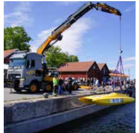
Hamnen i Öregrund har ingen fast kran, men för arrangemang kan kranbil hyras in för att lägga i större och mer känsliga båtar.
