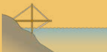
Konsolbrygga med pelare fäst mot berg.
